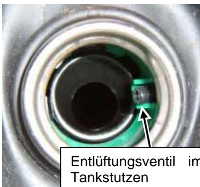
Die Befüllung des Luftpolsters kann jedoch auch versehentlich passieren, indem man das Entlüftungsventil mit der Zapfpistole unbewusst oder versehentlich betätigt.
